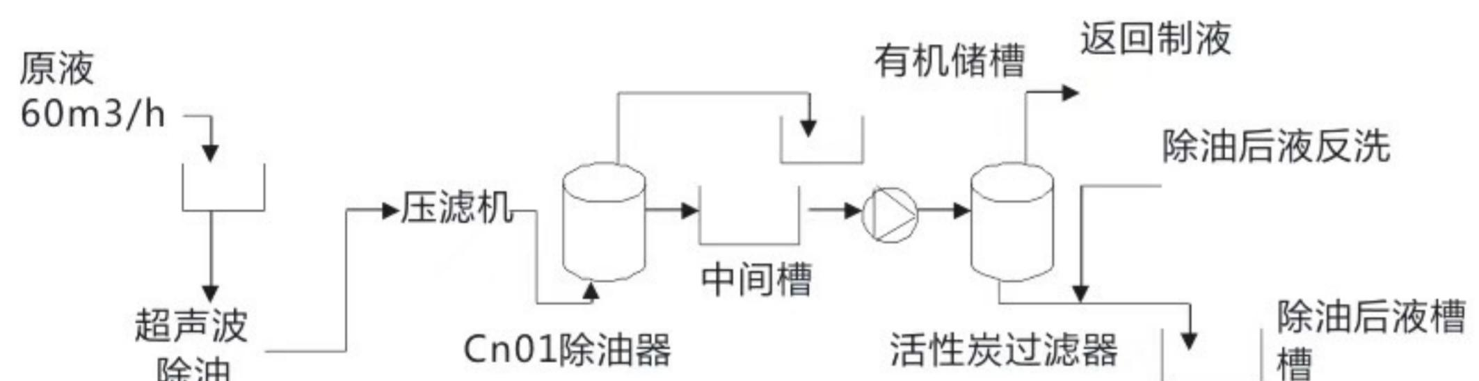
工艺简述：原液经萃取后含微量煤油，依次经超声波回收除油和活性炭过滤吸附除油后得到较纯净的除油后液。吸附饱和的活性炭转变为危险废物废活性炭。
