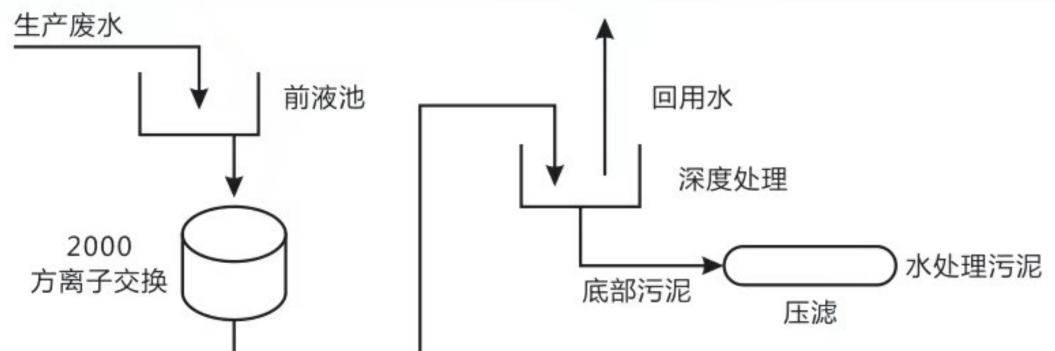
工艺简述：生产废水经前液池中转进入2000方离子交换后得到含微量镍金属的处理后液，再经深度处理后得到合格水进行回用。深度处理过程中，底部会逐渐沉积极少量的污泥，经一段时间累积后，将该累积污泥压滤后产生水处理污泥。
