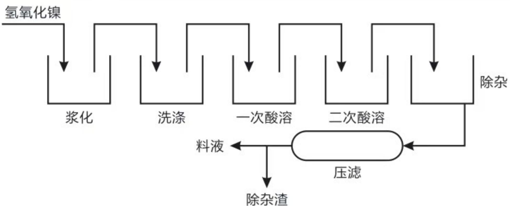
工艺简述：氢氧化镍原料依次经过浆化和洗涤、一次酸溶、二次酸溶得到酸溶原液，该液经过除杂后压滤产生少量的除杂渣。该渣含有微量未浸出的镍金属。
