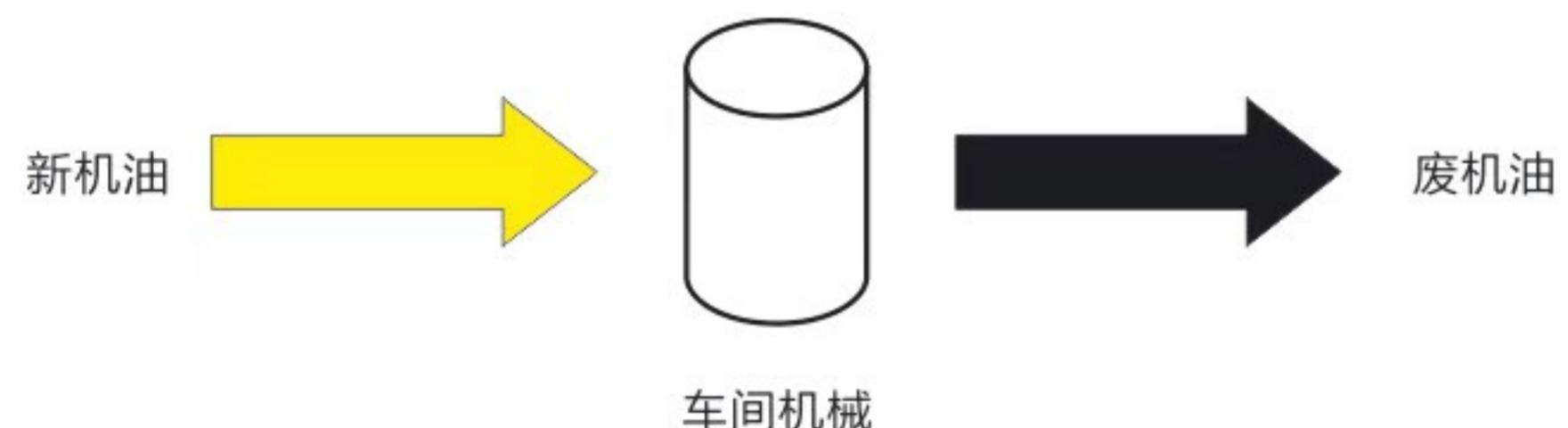
工艺简述：新机油经过车间机械使用一段时间后，水分变少，颜色变黑，粘度增大，并混入机件磨损产生的少量金属粉末等杂质，将该使用过的机油更换出来后产生废机油。
